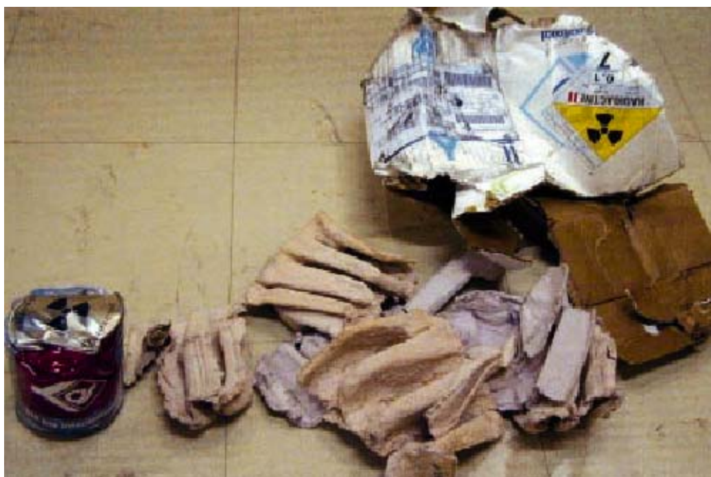
Figure 4 : Débris d'un colis de type A accidenté sur une plate-forme aéroportuaire
