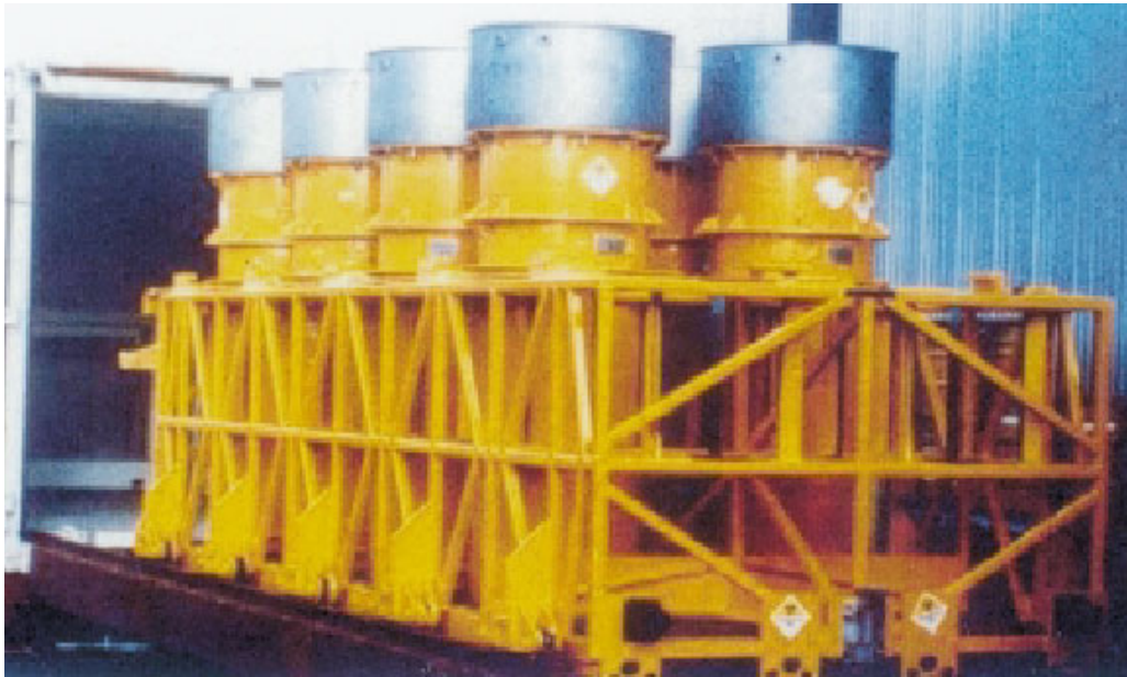
Figure 3 : Une cargaison de plutonium de FS47 maintenus verticalement dans un râtelier, en cours de chargement dans un camion non blindé, conformément aux dispositions courantes en France
